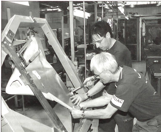
Die Montage der Flügelenden für Verkehrsflugzeuge benötigt viel Handarbeit.
