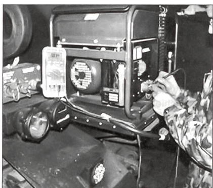
Überprüfen der elektrischen Anlage durch den Diagnostiker.
