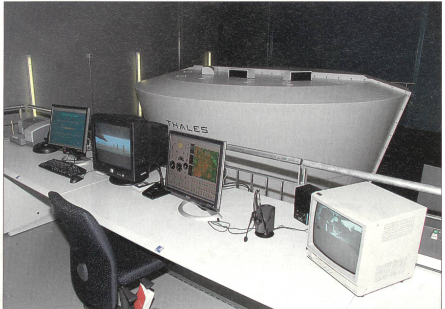
Die neuen Fahrschulanlagen in Thun umfassen je vier Simulatoren für die Kampfpanzer Leopard und Schützenpanzer 2000, was die gleichzeitige Schulung von vier Fahrern gestattet.
