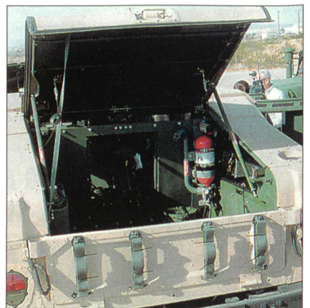
HMMWV mit Feuerunterdrückungssystem und vergrößerter Heck(Not)Ausstiegsluke.
