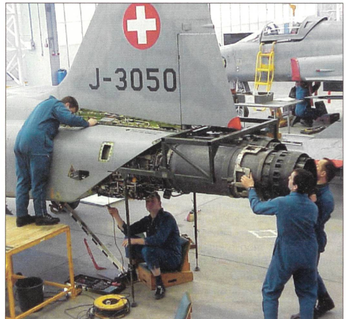
Fliegersoldaten beim Einbau eines Triebwerks am F-5 Tiger.
