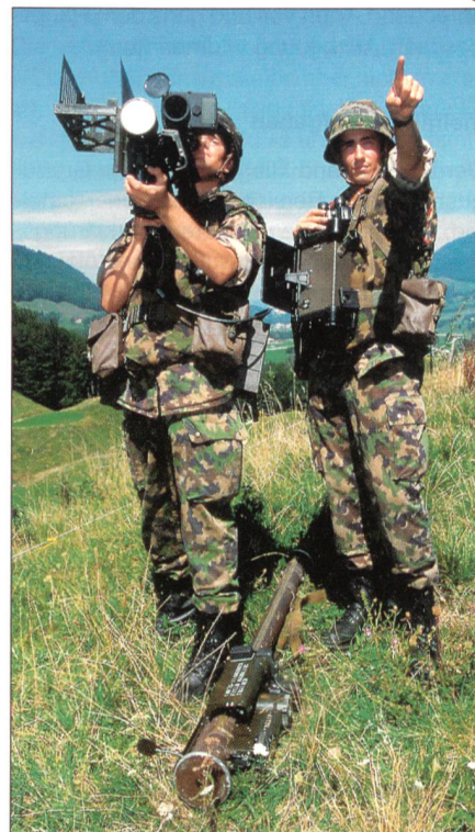
Die leichte Fliegerabwehr lenk waffe BL 94 Stinger – eine von einer Person zu bedienende und ab Schulter abzufeuern de Lenk waffe für tieffliegende Ziele.
