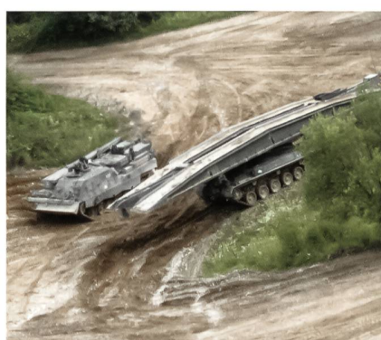
Bergepanzer Büffel und Brückenleger.
