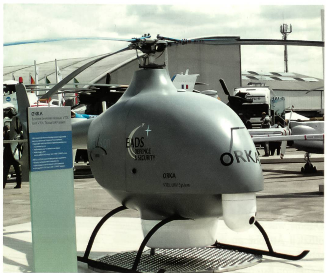
Unbemannte Flugzeuge, sogenannte Drohnen, finden immer breiteren Anklang. Das Bild zeigt das System ORKA, eine taktische Aufklärungsdrohne von EADS.
