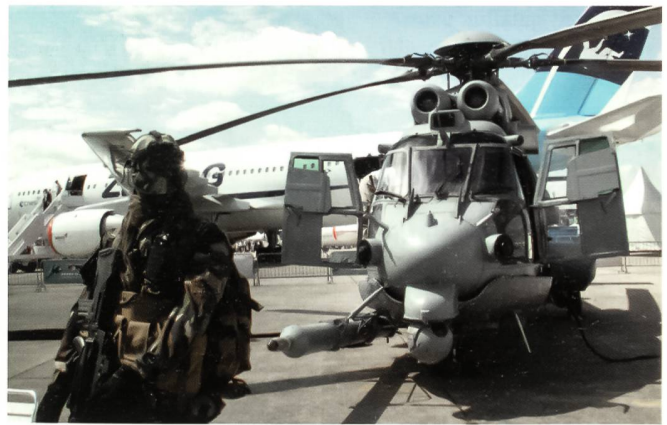
Flugzeuge und Helikopter werden zunehmend für Aufgaben von Spezialkräften eingesetzt (Special Forces). Diese Aufnahme zeigt eine Version des Super Pumas für die französischen Spezialkräfte, seitlich mit Luftbetankungsvorrichtung.
