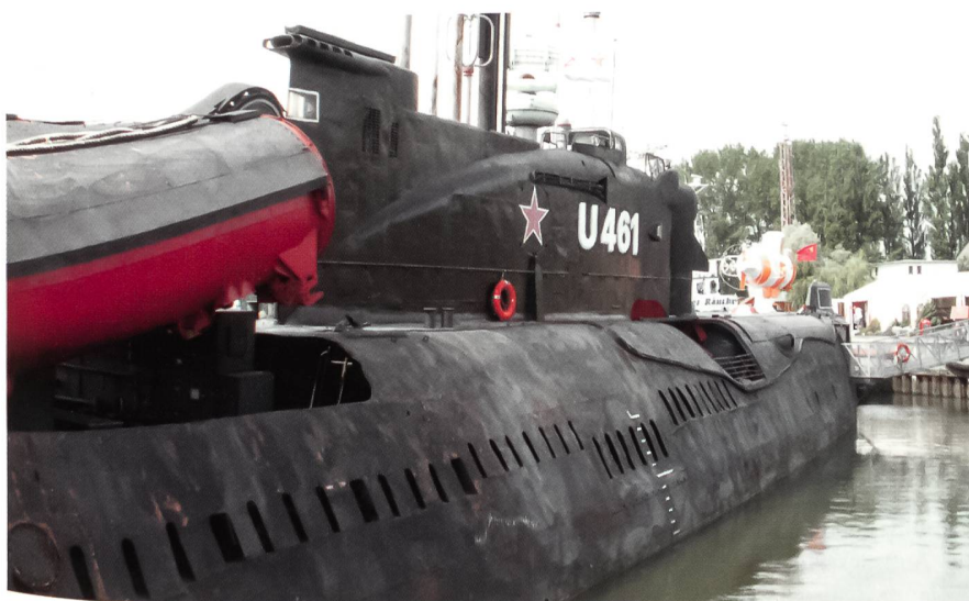
In unmittelbarer Nähe des Museums von Peenemünde kann auch dieses ehemalige sowjetische konventionelle Uboot der Juliett-Klasse besichtigt werden. Seine Hauptbewaffnung waren vier SS-N-3 Shaddock-Marschflugkörper, die zum Einsatz gegen alliierte Überwasser-Kampfschiffe geplant waren.
