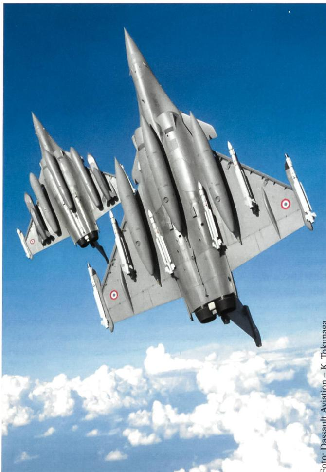
Eine Doppelpatrouille Rafale der französischen Luftwaffe, ausgerüstet mit drei Zusatztanks mit je 2000 Litern Treibstoff und sechs Luft-Luft-Lenk Waffen vom Typ MICA EM/IR.
