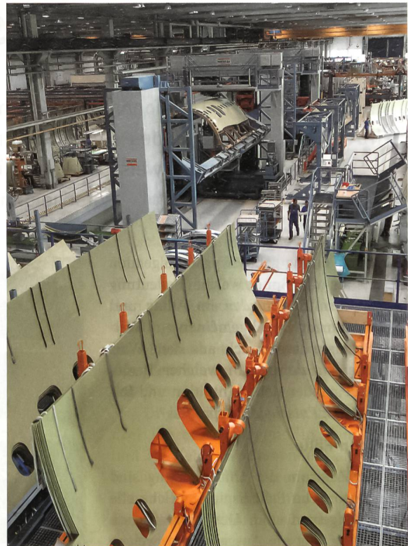
Für die Fertigung von Seitenschalen für das Passagierflugzeug Airbus A320 werden in Oberpfaffenhofen modernste Nietroboter eingesetzt.
