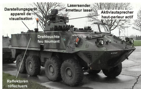
Die Simulatorenausrüstung mit Lasersender, Reflektoren, Empfänger, Darstellungsgarät, Drehleuchte und Aktivlautsprecher.
