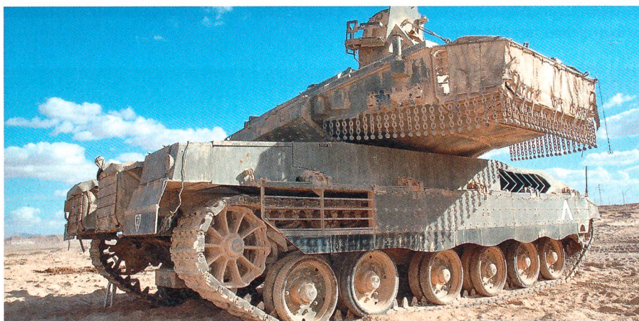
Seitenansicht des Merkava IV mit gedrehtem Turm. Viele Details wie zum Beispiel die «Ball-and-Chain»-Schutzketten an der Turmunterseite können so erkannt werden.
