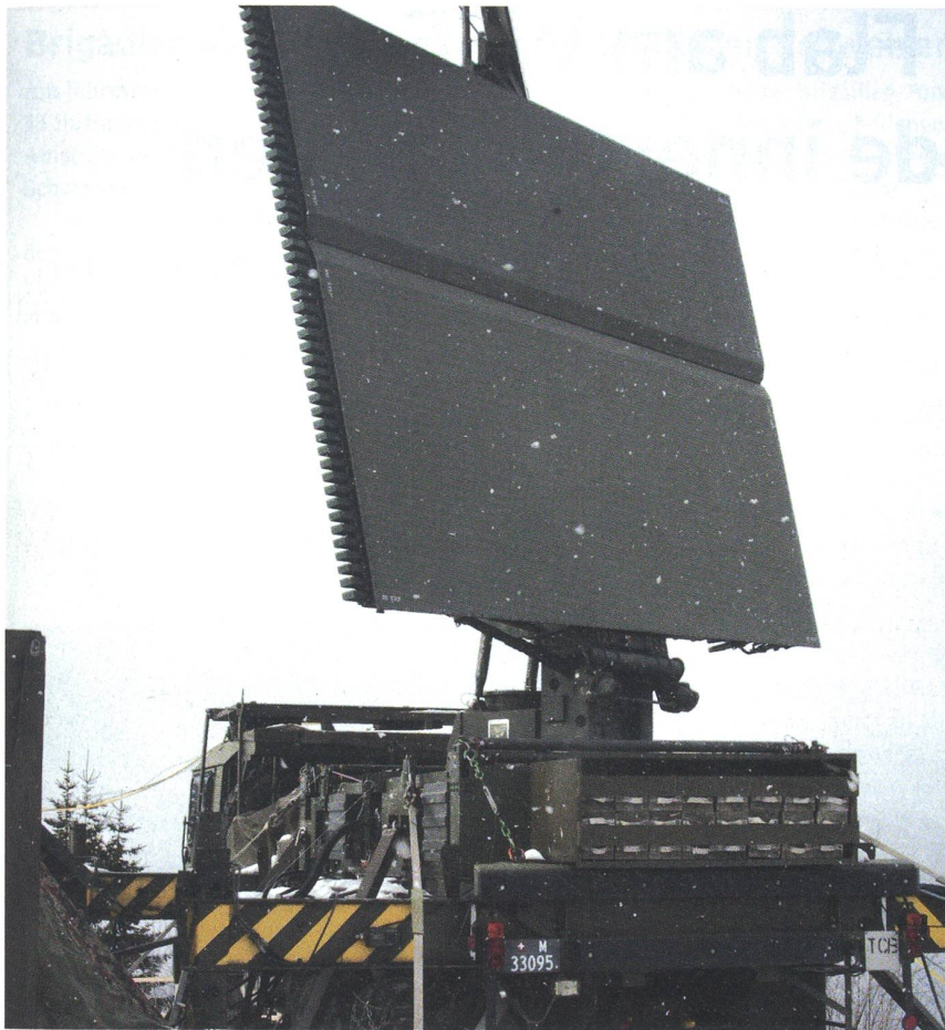
Liefert auch bei Minustemperaturen einwandfreie Radarbilder: Das TAFLIR, das Taktische Fliegerradar der Schweizer Armee.
