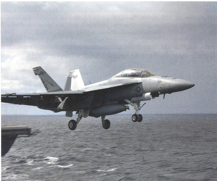
Eine F/A-18F «Super Hornet» der Fighter-Attack Squadron VFA-211 («Checkmates») wird vom Dampfkatapult Nummer 3 der USS «Enterprise» (CVN 65) gestartet. Nach der 90 Meter langen Strecke erreicht die Maschine eine Geschwindigkeit von 220 km/h.
