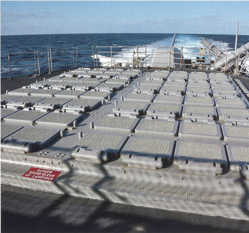
Zur Hauptbewaffnung der USS «Leyte Gulf» (CG 55) gehören zwei VLS (Vertical Launch Systems), welche über je 61 Startschächte für «Standard» SM-2 See-Luft-Lenk Waffen, «Tomahawk»-Marschflugkörper und «Asroc» Torpedos enthalten. Diese Aufnahme zeigt das VLS am Heck, ein 12,7 cm Geschütz sowie die acht «Harpoon» Schiff-Schiff-Werfer.
