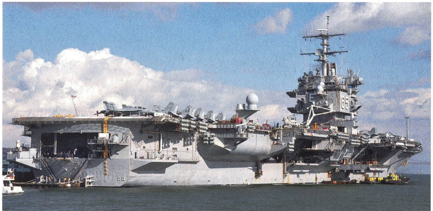
Ein Aufnahme der USS «Enterprise» (CVN 65) am Tag vor dem Auslaufen aus Lissabon. Der Träger ist 338 m lang, 77 m breit und verdrängt 95 000 Tonnen. An Bord sind 61 Flugzeuge des Marineflieger Geschwaders 1.
