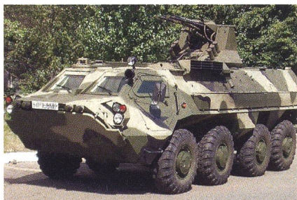
BTR-4 Radschützenpanzer mit fernbedienter Waffenstation und 23-mm-Zwillingskanone.
