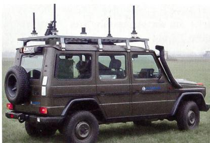
Cassidian «Vehicle Protection Jammer» auf einem Versuchsfahrzeug.
