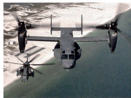
Zwei Turbopropeller-Triebwerke des Typs AE 1107C an einem V-22 Osprey.
