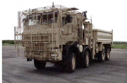
Britischer Iveco Trakker 8x8 mit Käfigpanzerung.
