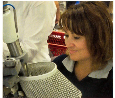
Frau Leonarda bei Schweissarbeiten. Goretex-Nähte sind zu verschweissen. HAIX legt auf gute Behandlung der Arbeitnehmer und deren Förderung Wert.
