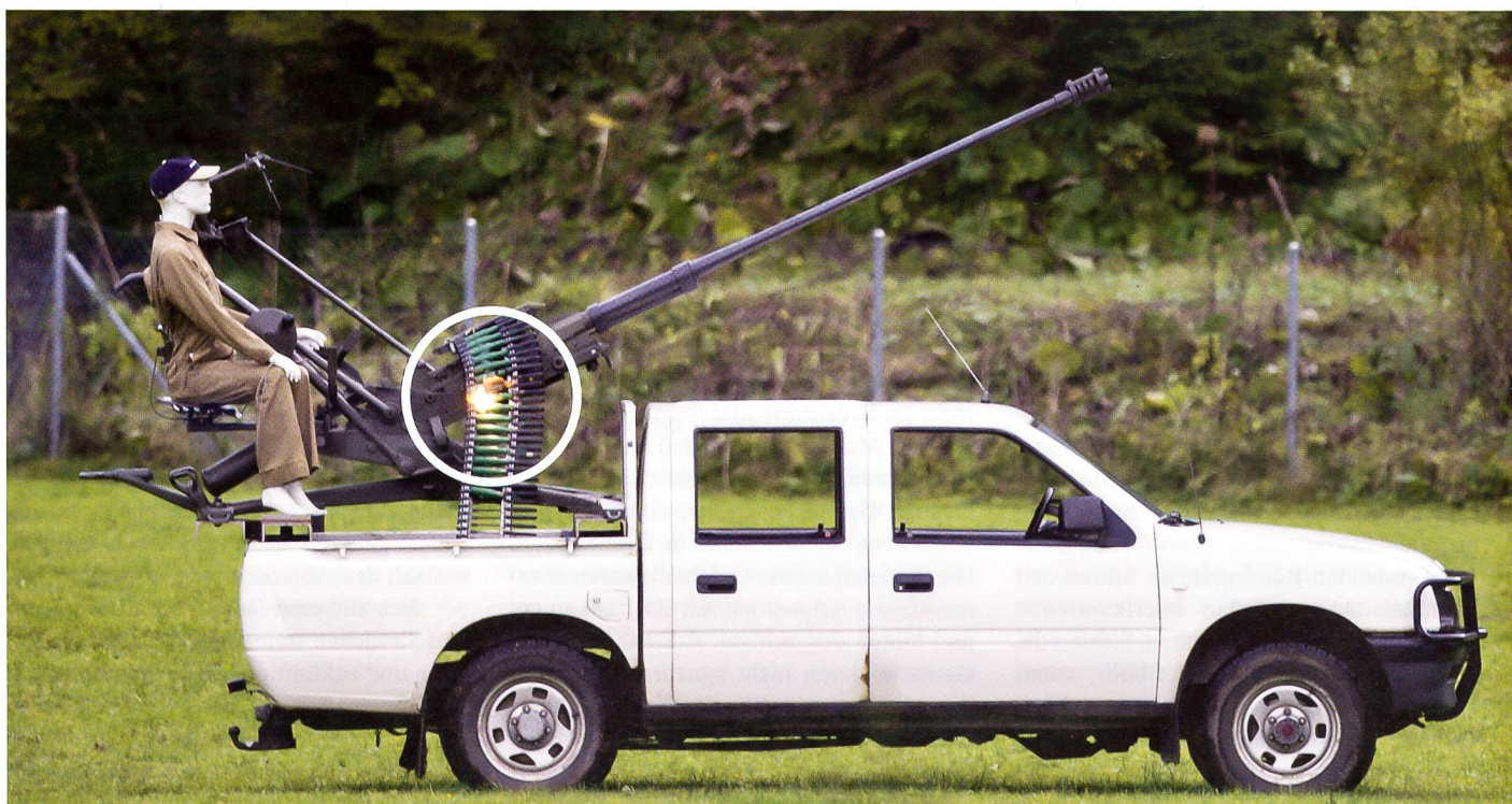
Die Besatzung des GTX Boxer war in der Lage, ein auf der Ladefläche eines fahrenden Pick-ups montiertes überschweres Maschinengewehr ausser Gefecht zu setzen, indem eine Patrone im Munitionsgurt «verbrannt» wurde, ohne den Schützen zu gefährden.
