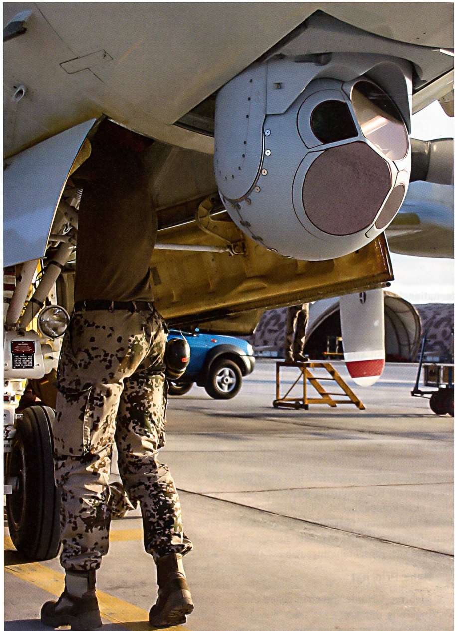
Das elektrooptische Kamerasystem MX-20HD ermöglicht gestochen scharfe Bilder aus grosser Höhe und weiter Entfernung.
