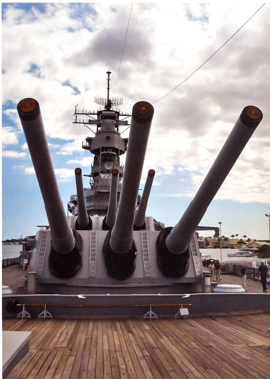
Blick vom Vorschiff der USS Missouri auf die vorderen Geschütztürme mit je drei 40,6-cm-Geschützen, die je rund 900 kg schwere Granaten über 42 km feuern konnten.
