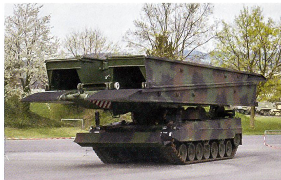
Neuer Brückenpanzer, pardon: Brückenlegesystem.
