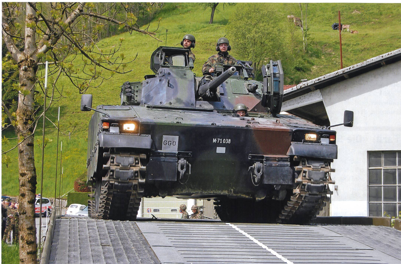
Schweres Gerät rollt über die Militärbrücke – unverkennbar ein Schützenpanzer 2000 (CV-90) mit seiner 30-mm-Kanone.
