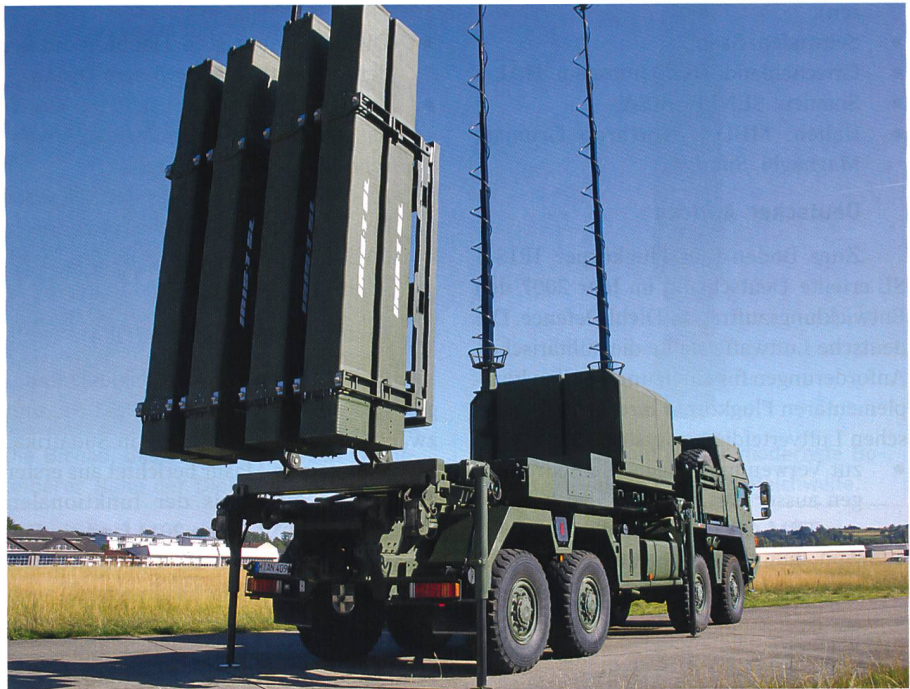
Die Fiberglas-Behälter für acht IRIS-T SL auf dem stark gepanzerten Trägerfahrzeug.
