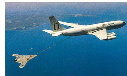
Erste vollautonome Luftbetankung eines unbemannten Luftfahrzeuges.
