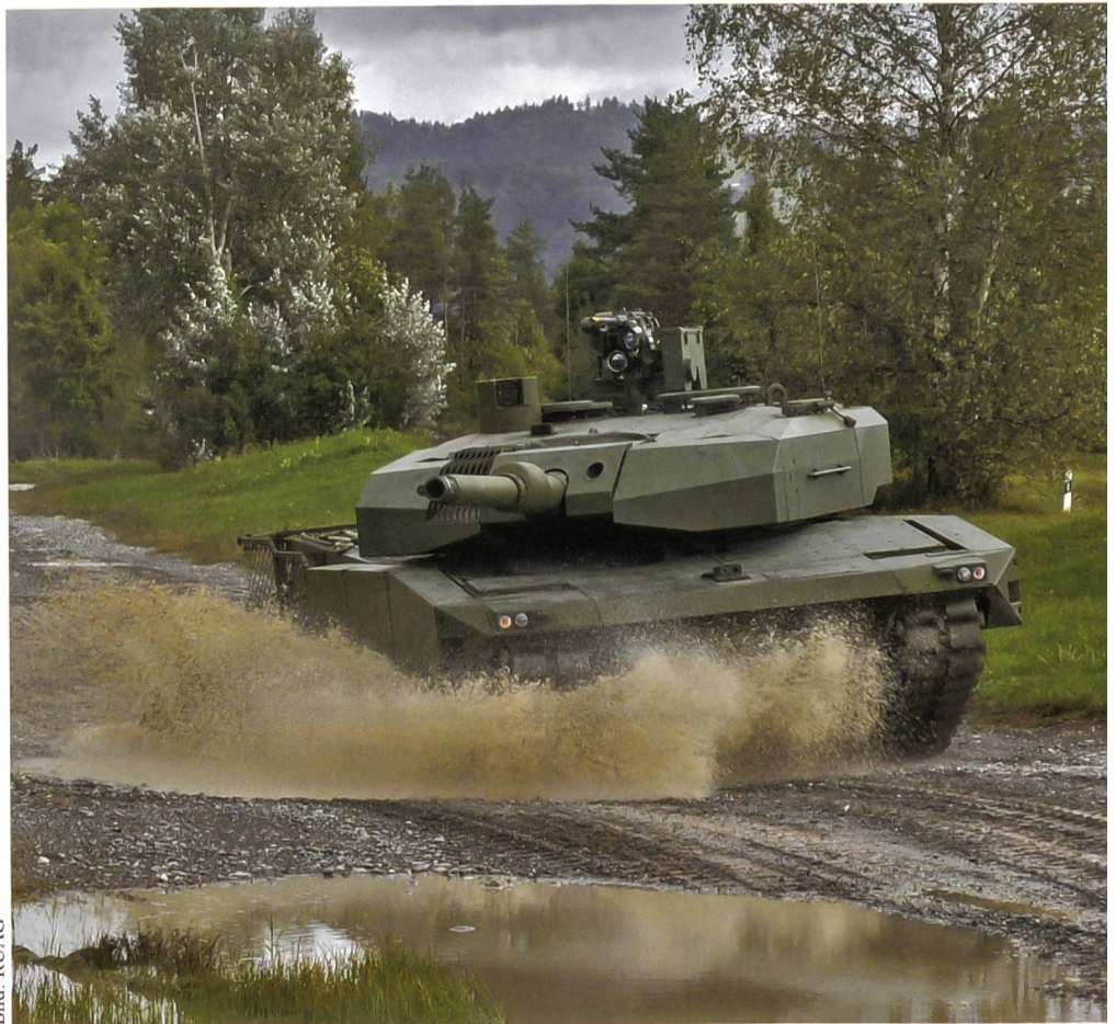
Auf dem Kampfpanzer Leopard ist das sogenannte SidePRO-ATR passive Schutzsystem der RUAG Defence montiert. Es schützt gegen Panzerabwehrwaffen wie RPG-7, gegen KE-Munition (Wuchtgeschosse) und gegen panzerbrechende Munition.
