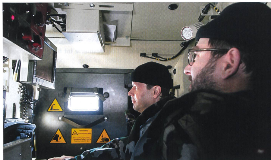
Die Feuerleitstelle befindet sich direkt auf jedem Geschütz hinter der Fahrerkabine.
