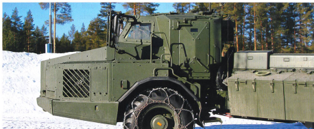
Gepanzerte Kabine des ARCHER bietet Schutz für Fahrer und Geschützbedienung.
