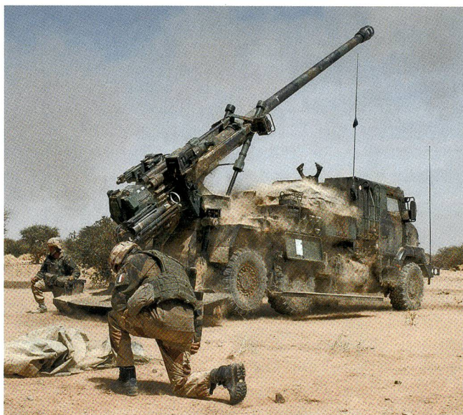
Der CAESAR im Kriegseinsatz in Mali. Gut erkennbar ist eine Schwäche des Systems: Die Kanoniere sind schlecht geschützt.
