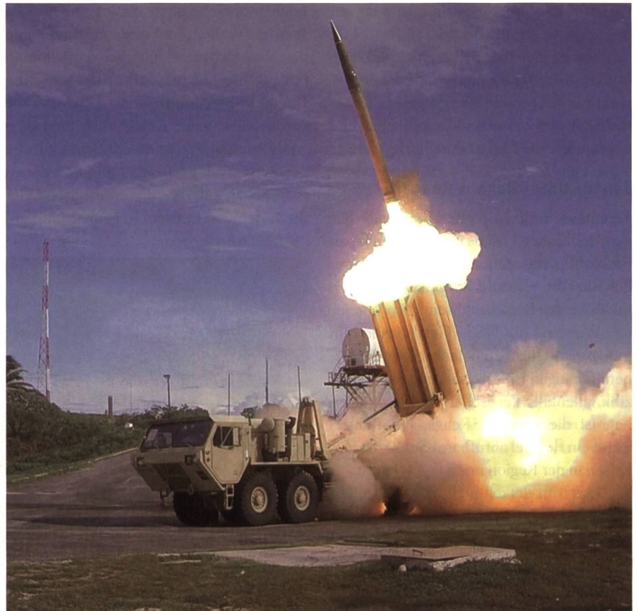
Das THAAD ist ein Raketenabwehrsystem des amerikanischen Heeres gegen feindliche ballistische Raketen, die einen Kriegsschauplatz oder eine Region bedrohen.
