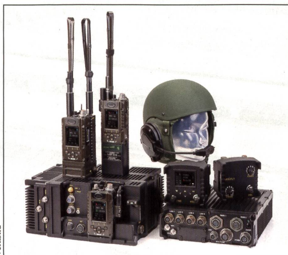
Das Elbit-System mit Boxen links und rechts. Sie sind fest im Fahrzeug eingebaut. Das linke Funkgerät mit Antennen dient dem Chef und das rechte trägt der Soldat. Die Geräte auf Box rechts dienen dem Fahrzeugführer und Beifahrer.
