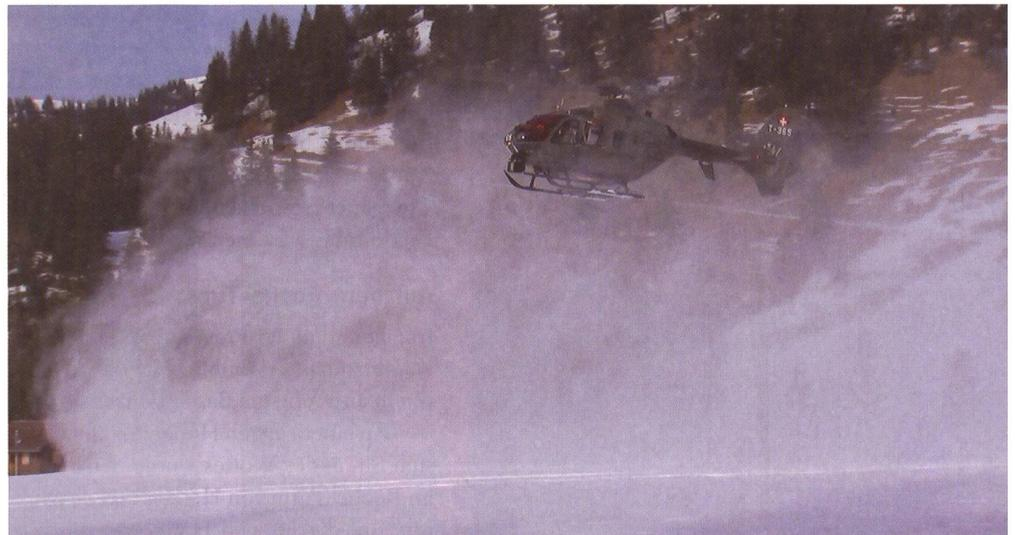
Aufgewirbelter Schnee hindert den Helikopter-Piloten am Abschätzen der Höhe.
