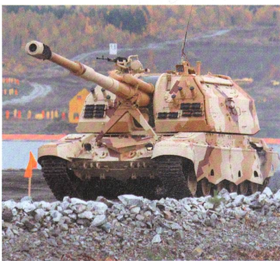
Die 152-mm-Panzerhaubitze Msta-S19 ist Russlands Standardgeschütz. 2020 wird 2S35-Koalizia-SW eingeführt.
