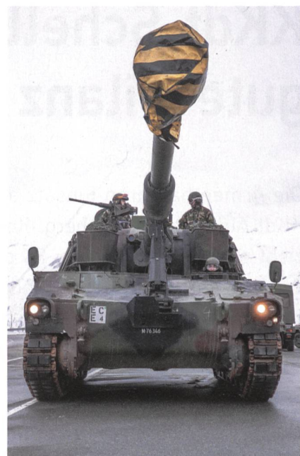
Die Hauptwaffe der Art Abt 49, die Pz Hb M-109 KAWEST, auf dem Simplon.
