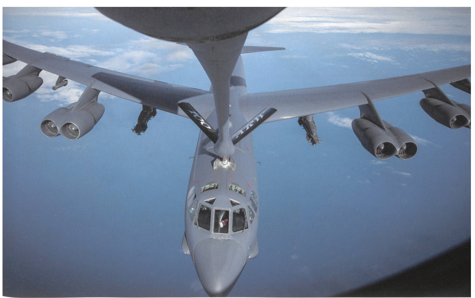
Auf dem Weg zum Persischen Golf wird eine B-52 Stratofortress der US Air Force von einem KC-135 Stratotanker aufgetankt.
