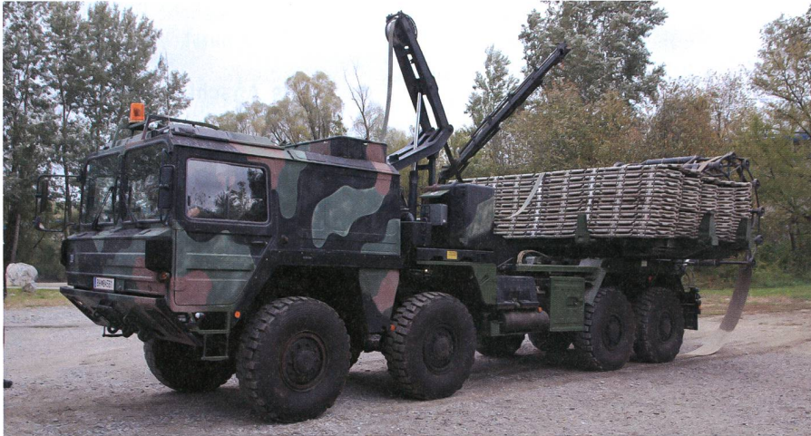
Faltstrassengerät: nach der Verlegung der Faltstrasse auf weichem, sandigem oder morastigen Untergrund kann diese mit schweren Fahrzeugen befahren werden.
