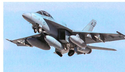
Super Hornet mit IRST-Block II-Behälter.
