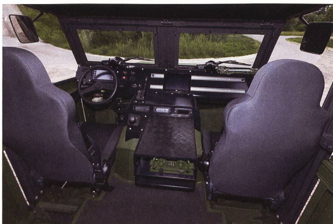
Ein Blick in die Kabine: Das Chassis basiert auf dem DURO und dem EAGLE.
