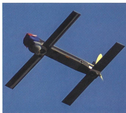
Switchblade-Drohne: Die USA haben bereits erste Drohnen ausgeliefert. Sie ist als Kamikaze-Drohne konstruiert worden und stürzt sich mit einer Explosionsladung auf zugewiesene Ziele.
