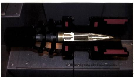
Die Zwillingskanone kann ebenfalls die 35-mm-AHEAD-Munition verschiessen. Diese Granate explodiert unmittelbar vor dem anvisierten Ziel in der Luft. Dadurch eignet sie sich zur Bekämpfung von Drohnen, Mörsergranaten und auch Helikoptern oder Jets.
