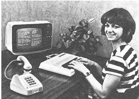
Wir möchten in diesem Bericht die Speichermöglichkeiten des COMBIPHON genauer betrachten. Die Grundausrüstung besitzt einen Speicher für über 900 Zeichen. Dieser ganze Text ist auf dem Bildschirm sichtbar, immer deutlich in zwei Blöcke unterteilt. Auf der einen Seite erscheint der eigene Text, auf der anderen der des Gesprächspartners. Sie können auf dem COMBIPHON-Bildschirm lesen wie in einem Buch.
