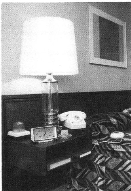
Technische Hilfsmittel von links nach rechts: Blitzrundleuchte, Blitzwecker mit steckbarem Kissenvibrator (ganz rechts im Bild), Telefonapparat mit angebautem Visotel und Hörer mit regulierbarer Lautstärke.
