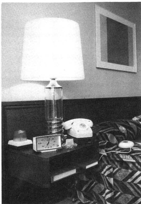
Technische Hilfsmittel von links nach rechts: Blitzrundleuchte, Blitzwecker mit steckbarem Kissenvibrator (ganz rechts im Bild), Telefonapparat mit angebaute Visotel und Hörer mit regulierbarer Lautstärke.
