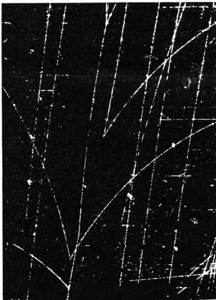
Abbildung 27 Beobachtung des \Omega^- -Hyperons in der Brookhaven (USA) Wasserstoffblasenkammer (s. dazu Text Abbildung 26)
