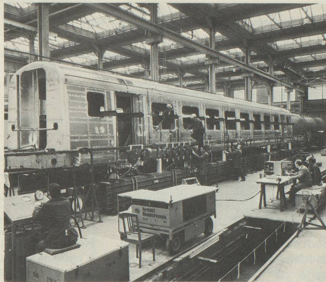
Construction d'un wagon CFF à Neuhausen (SIG).
