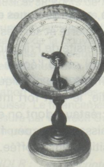
H. totale : 18,5 cm ; D. du disque gradué : 11,5 cm Inscription : Balance élastique inventée par Ferdinand Berthoud.
