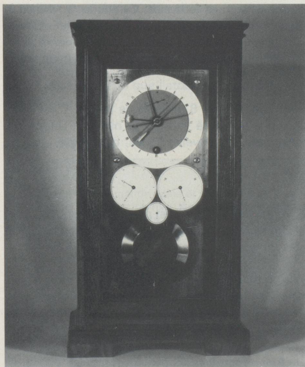
Horloge astronomique à 4 cadrans avec double tour d'heures : décimal et sexagésimal, quantième, lever et coucher du soleil à Paris, lat. 48° 50' 15". Mouvement à clé, à ressort. Echappement à cheville. Pendule compensateur à gril. Suspension à couteau. Antide Janvier, au Louvre n° 347, Paris, 1802 1751-1835
