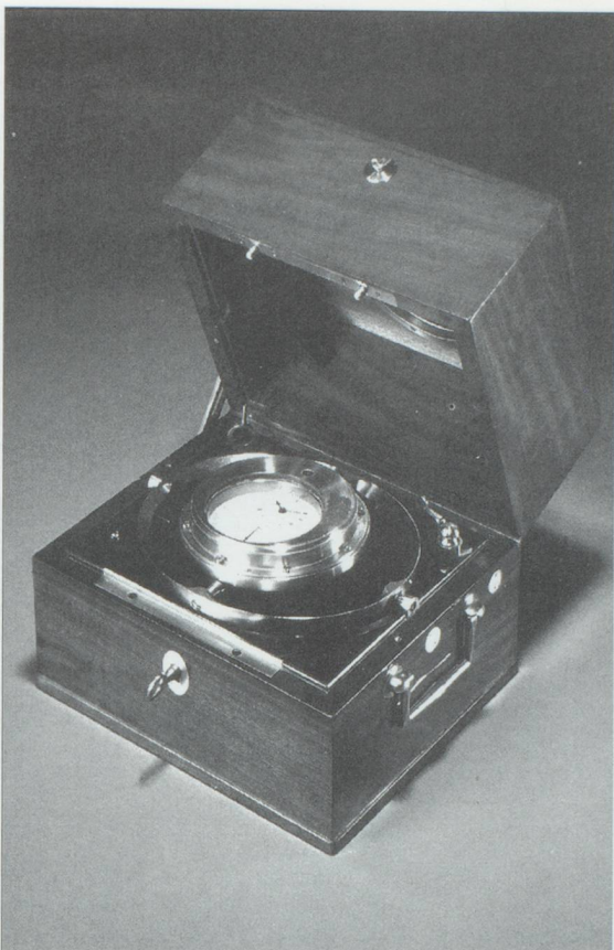
Chronomètre de marine à deux barillets, réalisé dans une boîte étanche et monté sur cardans dans un coffret d'acajou. Modèle acheté par le Ministère de la Marine française entre 1827 et 1831.
