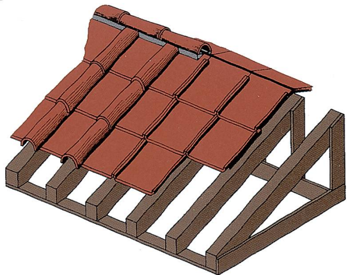
Abb. 17 Rekonstruktionszeichnung eines römischen Ziegeldaches.
