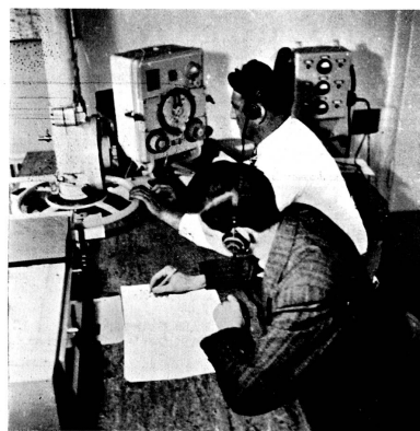
Der Funker am Nahzonenpeiler. Im Hintergrund rechts das Bakenkontrollgerät zur Betätigung der Blindlandeanlage.
