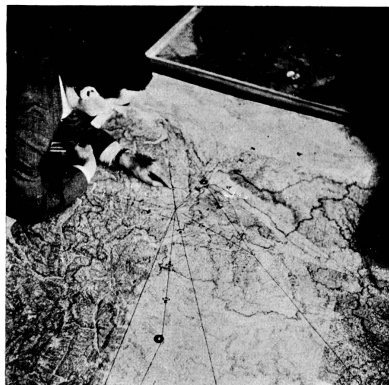
Ing. Meyer an der Verkehrskontrollkarte. Die Positionen der Zürich anfliegenden Flugzeuge sind durch Pappmodelle festgehalten, so dass der Verkehrskontrolleur einen genauen Ueberblick über die Dübendorf berührenden Maschinen hat.
