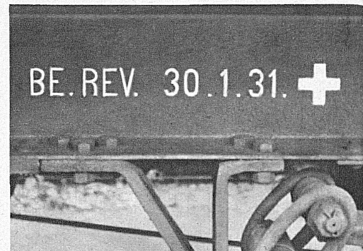
7. Unten: Die Notbremse muss zuverlässig sein. Letzte Erprobung im Okt. 1930, „weisses Kreuz“
